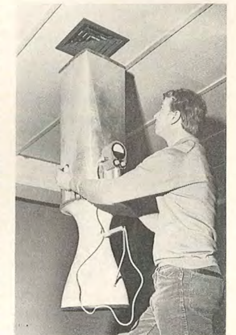
Fig. 2. Volumenstrømmåleren i anvendelse ved en kvadratisk anemostat. Overgangsrøret er forsynet med et par håndtag og en holder til viserinstrumentet.
