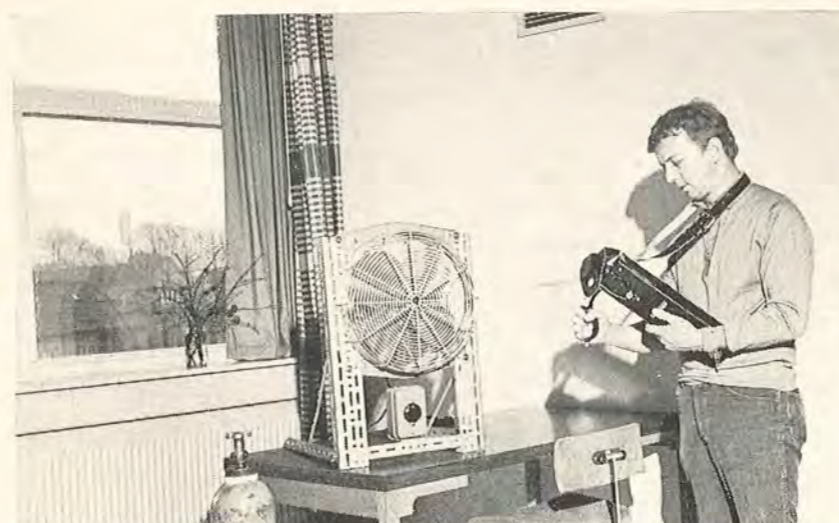
Fig. 3. En luftskiftemåling. Sporgassen er kuldioxid, måleinstrumentet en Riken gasanalysator. Ventilatoren bruges til opblanding af sporgassen.
